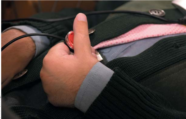
Le contacteur au pouce relié à une prise USB permet à l'utilisateur de cliquer.
